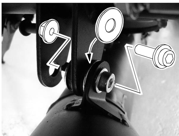
各ボルトナット類の締め忘れが無いか確認します。
