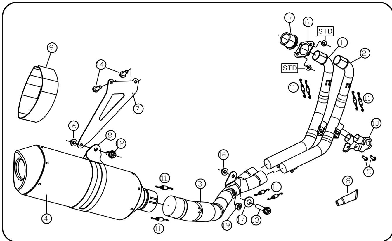
※図中「STD」とはメーカー純正部品の事であり、本製品の取り付けに流用します。
