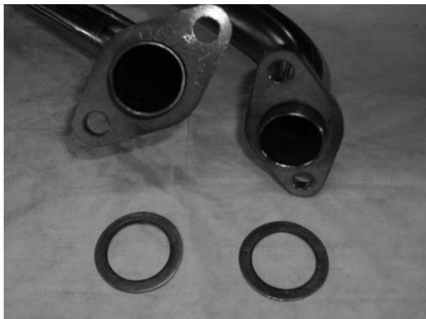
② 付属のガスケットを挿し込みます。
