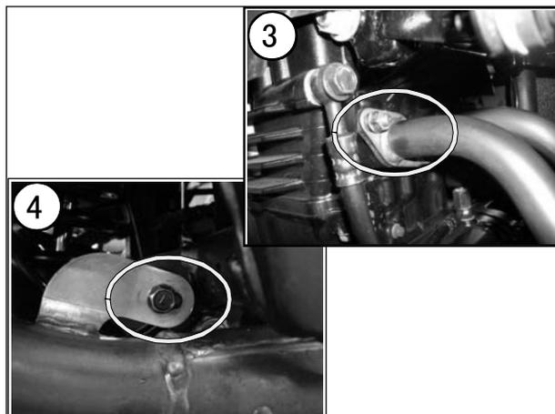
A/Fセンサー、フランジナット4本、マフラスターのボルト、ナット、ワッシャーは本製品取り付けに使用します。
