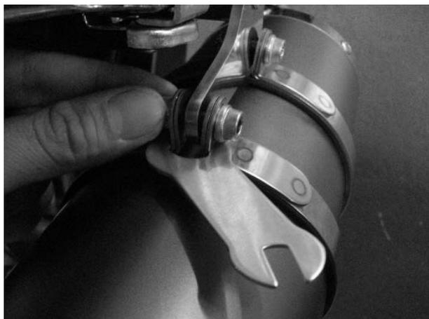
① 仮付けしておいたフロントパイプ # 1、# 2 を締め付けます。
