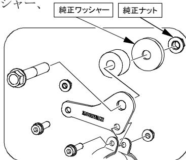
(フランジボルト 10、ナット 10 /締付トルク:3.5Kgf・m/34N・m)
