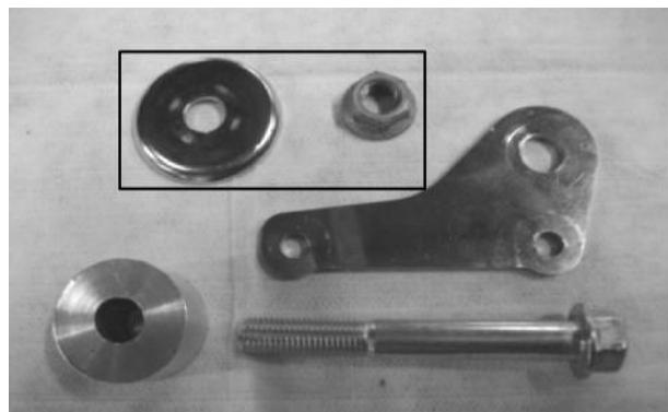
付属のフランジボルト 10x75、付属のサイレンサーバンドステー、付属のカラー 29x10x20、純正ワッシャー、の順に車体にセットし
