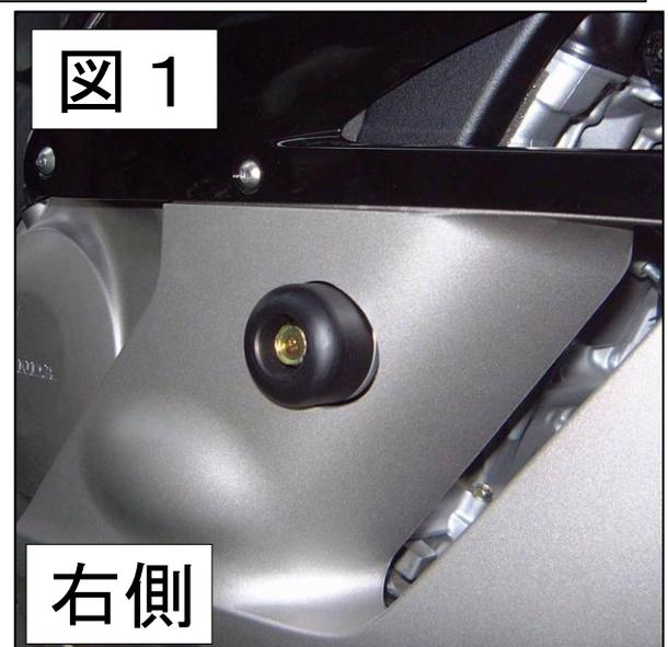
スキッドパッドの取付けは、必ず、片側ずつ行なって下さい。両側のエンジンハンガーボルトを一度にはずすと、エンジンが移動して、ボルトが入らなくなる恐れがあります。
