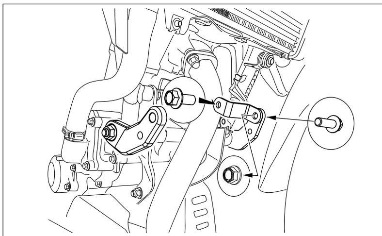
4. 右側の⑧マウントステー（“R”刻印付き）を取付け、⑤ベースプレートRの取付け穴を合わせ⑬ボルト、⑮ナットで固定する。
