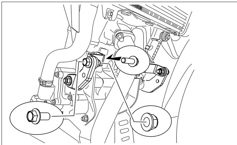
5. 仮組中の⑩長いボルト、と純正(STD)ナットを締め付け固定する。
