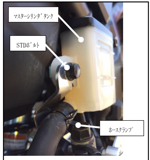
図3 マスターシリンダタンク取付
