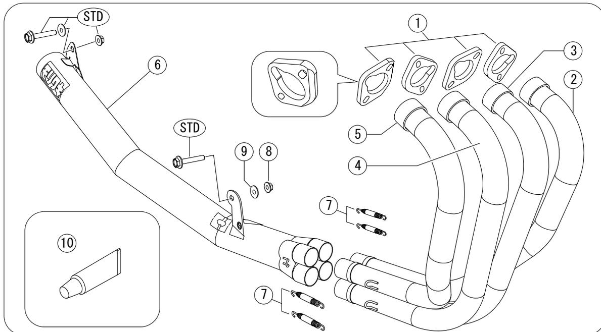
※図中「STD」とは車両メーカーの純正部品のことであり、取り付けに流用します。
