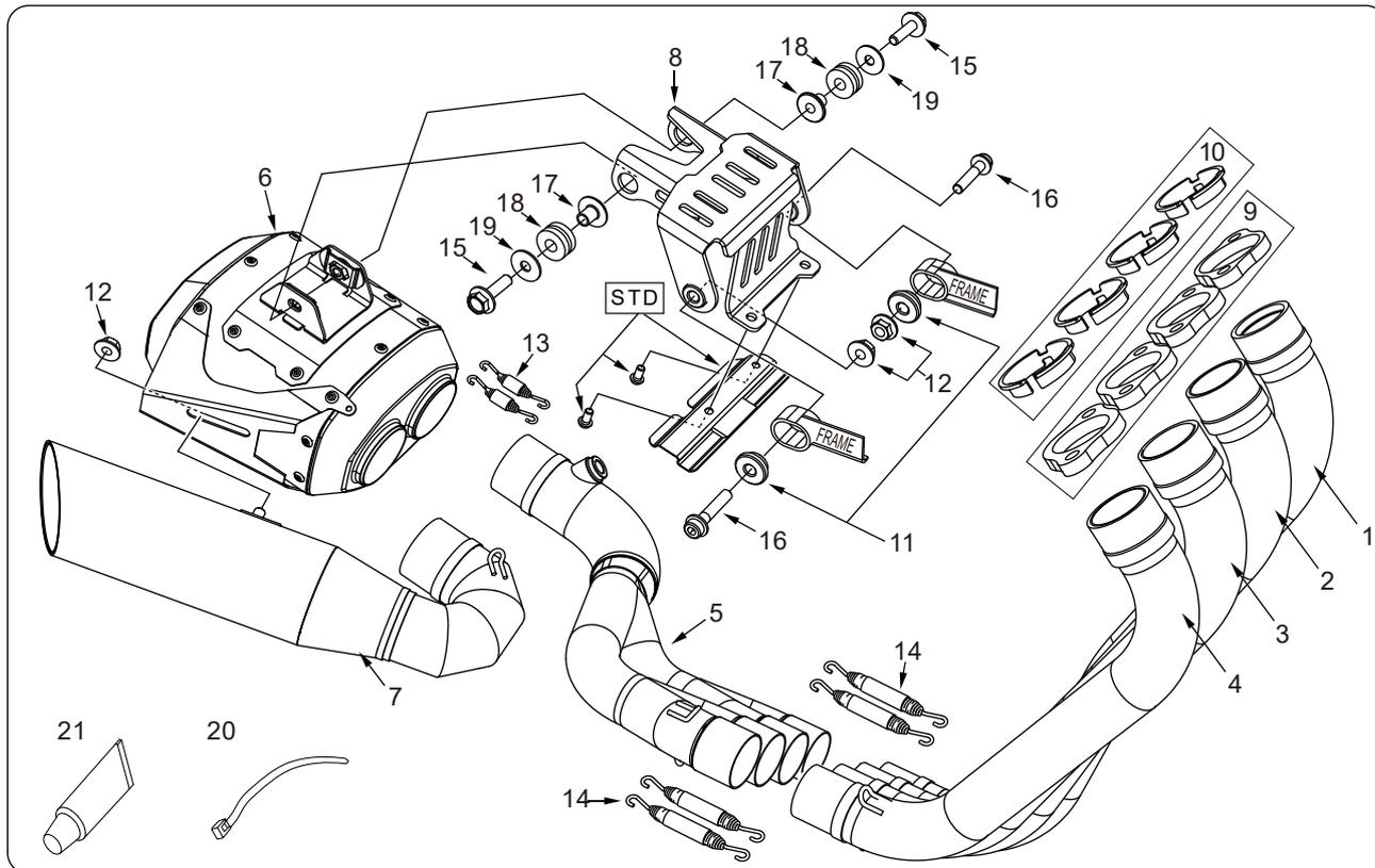
図中 [STD] とはメーカー純正部品のことであり、取り付けに再使用します。
