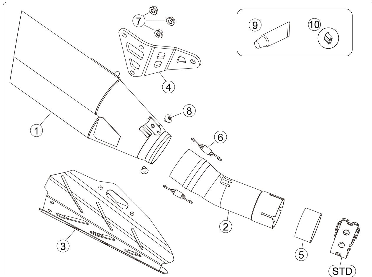
※図中「STD」とは車両メーカーの純正部品の事です。製品取り付けに再使用します。
