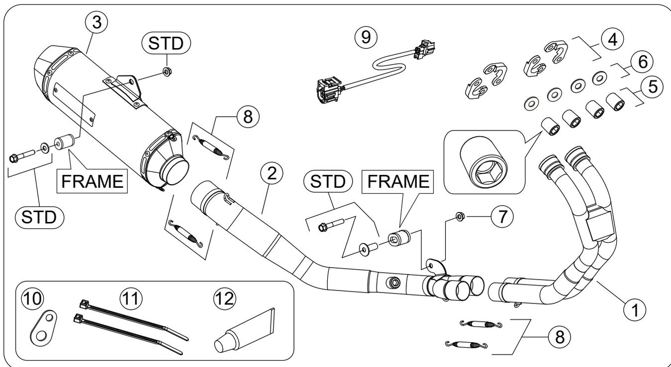
※図中「STD」とは車両メーカーの純正部品の事です。製品取付けに再使用します。
