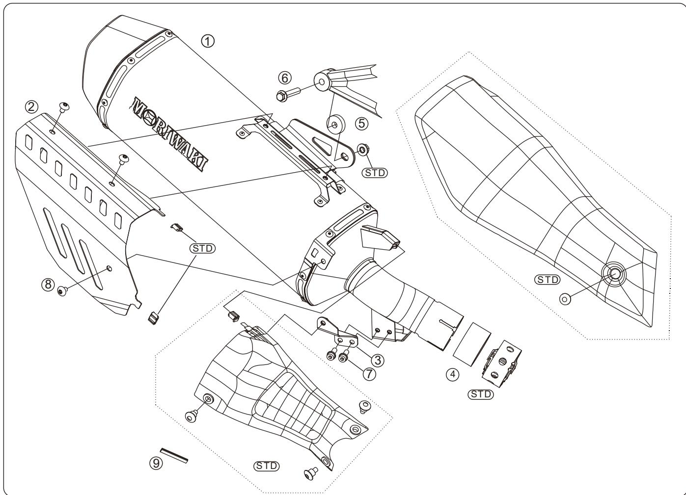
※図中「STD」とは車両メーカーの純正部品の事です。製品取り付けに再使用します。
