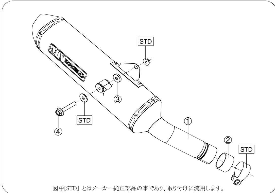
図中[STD]とはメーカー純正部品の事であり、取り付けに流用します。
