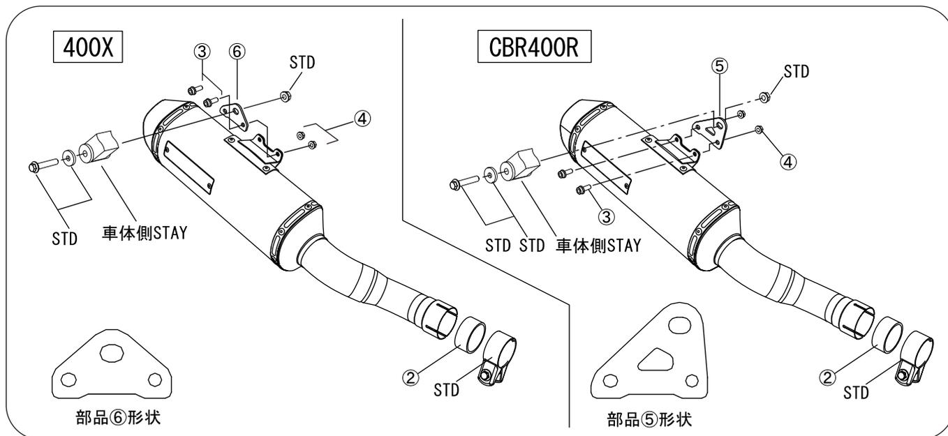
※図中「STD」とはメーカー純正部品の事です。製品取り付けに再使用します。
