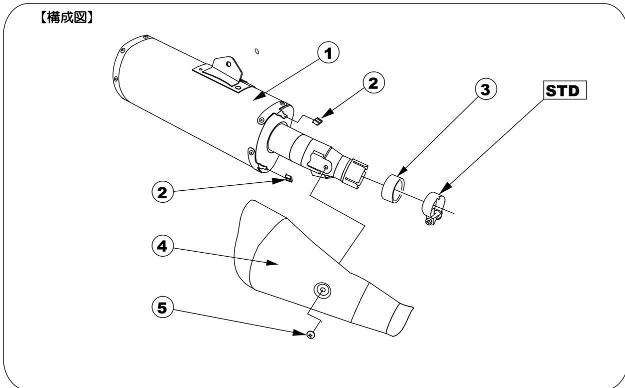
※STDとは車両メーカーの純正部品の事です。製品取り付けに再使用します。
