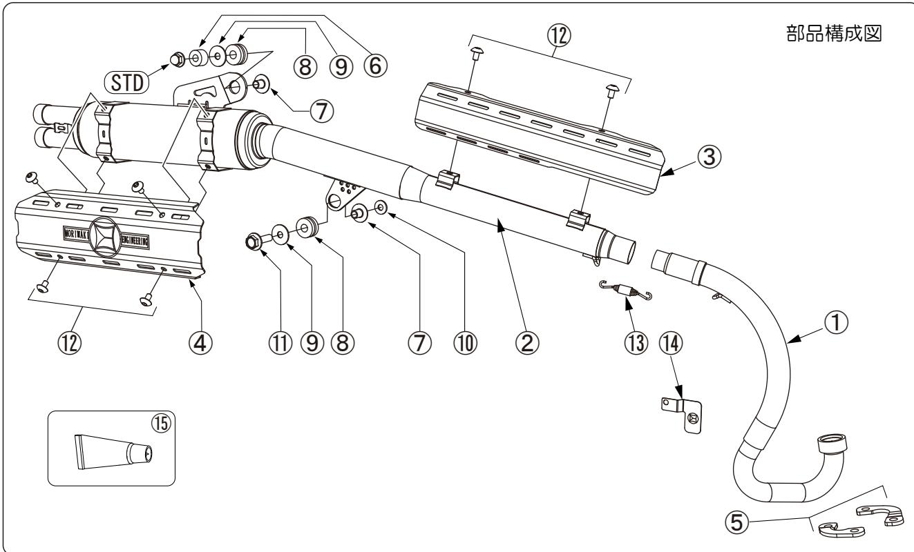
※図中の STD とは、車体から取り外した純正パーツで、再使用します。
