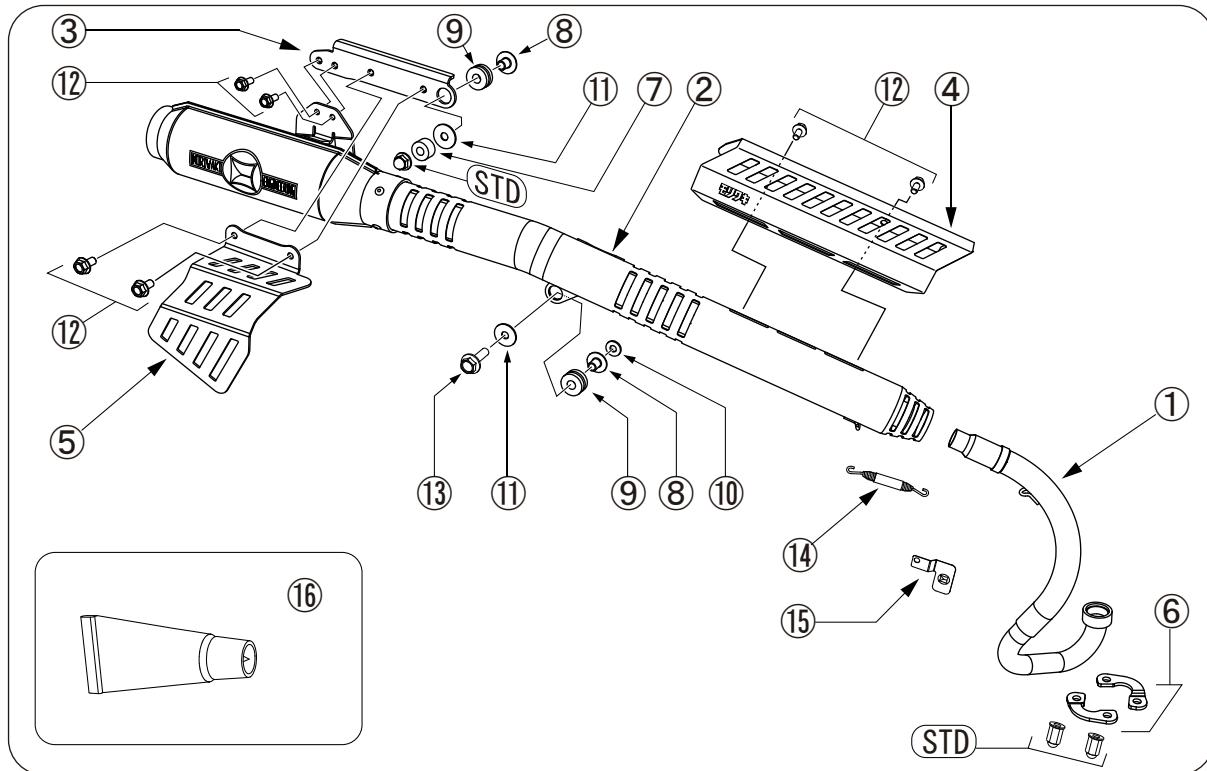
※図中の STD とは、車体から取り外した純正パーツで、再使用します。
