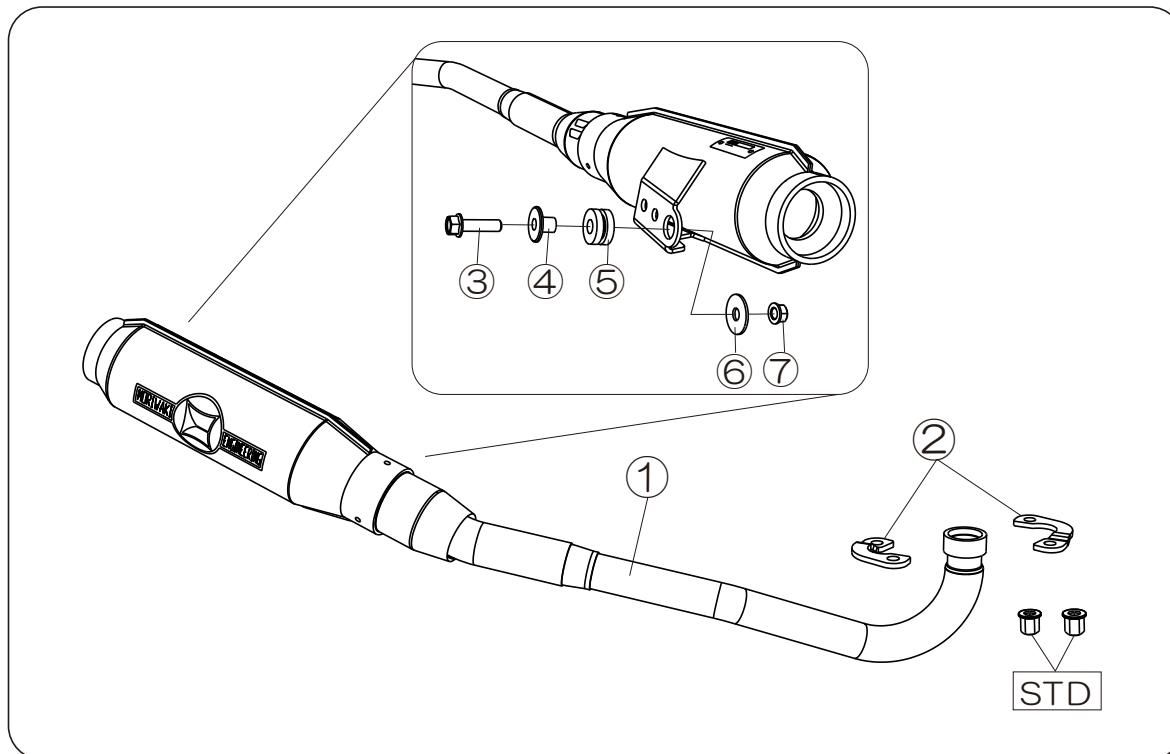
※図中「STD」とはメーカー純正部品の事です。製品取り付けに再使用します。
