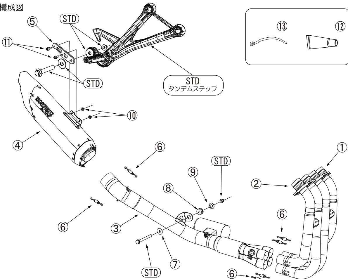
※図中「STD」とは車両メーカーの純正部品の事です。製品取り付けに再使用します。
