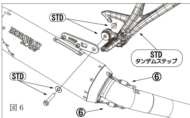
※サイレンサーサブステーは車体タンデムステップの外側になるように取り付けて下さい。
