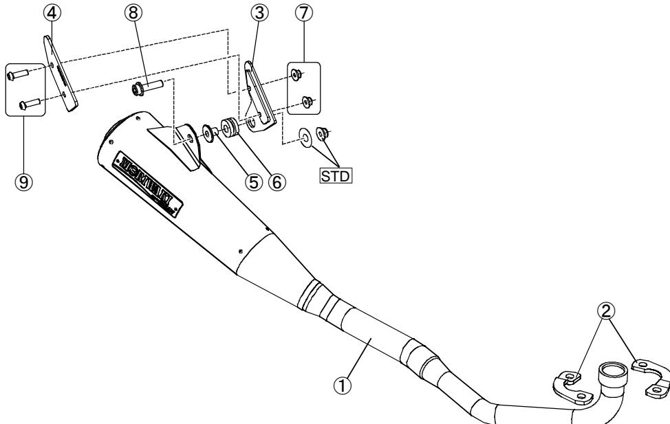
図中[STD]とはメーカー純正部品の事であり、取り付けに流用します。
