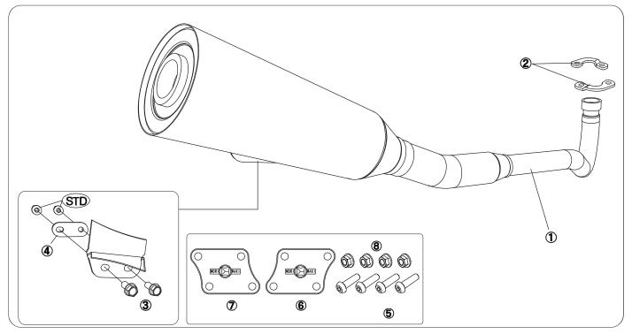
※図中「STD」とはメーカー純正部品の事です。製品取り付けに再使用します。
