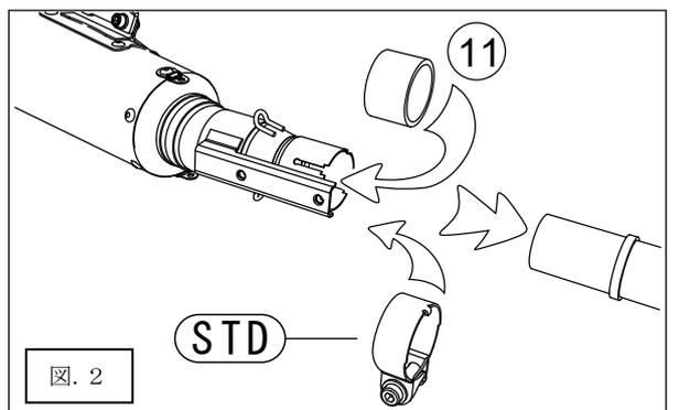
GB350 は STD のボルト、ワッシャー、ナットを使用してサイレンサーを車体へ仮組して下さい。
