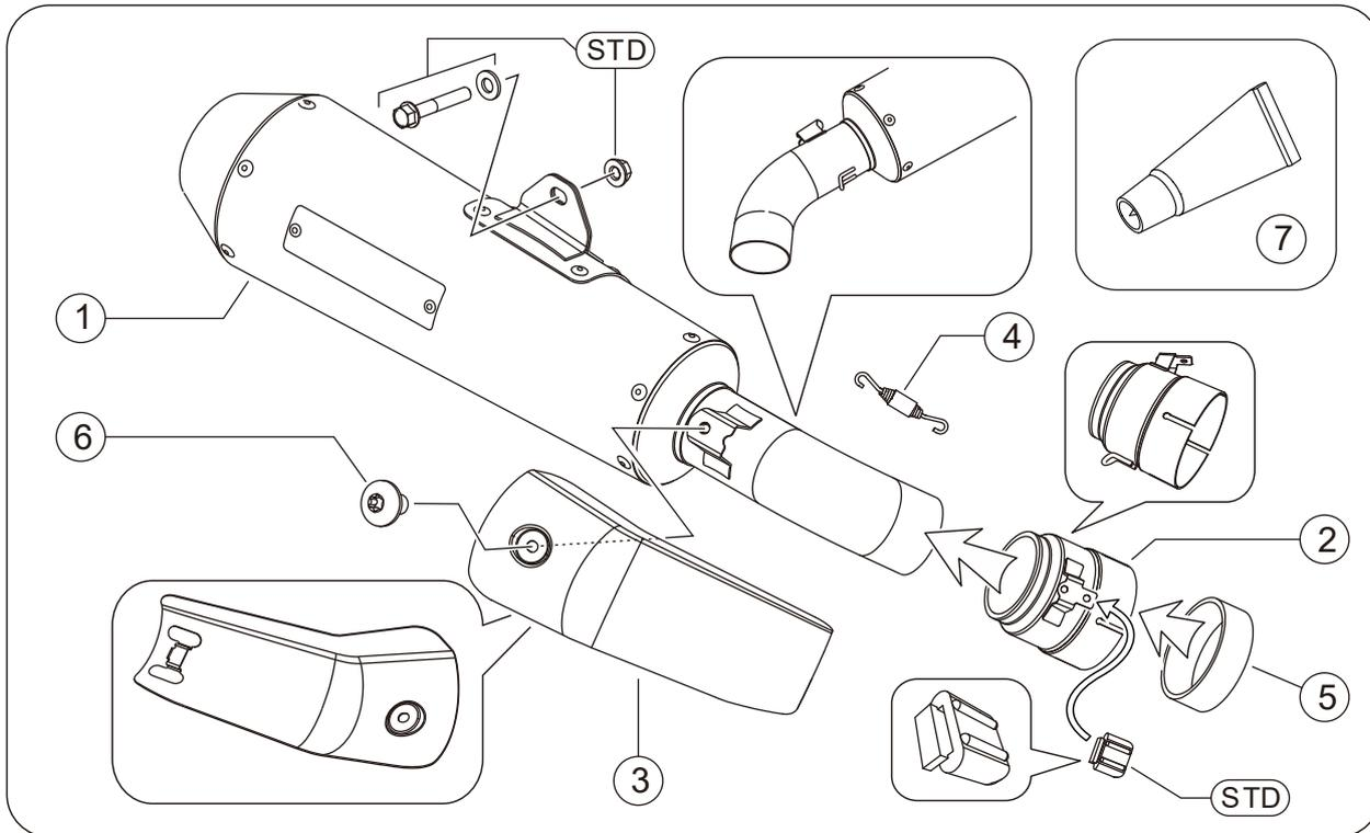
※図中「STD」とは車両メーカーの純正部品の事です。製品取り付けに再使用します。
