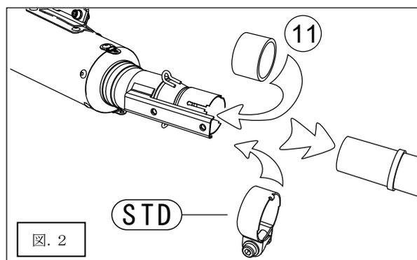
GB350はSTDのボルト、ワッシャー、ナットを使用してサイレンサーを車体へ仮組して下さい。
