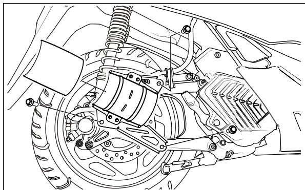
仮組みにはフランジボルト M10×30(付属品⑧)を使用し、同時にブラケットラバー(付属品⑤)をブラケットへ貼り付けます。
