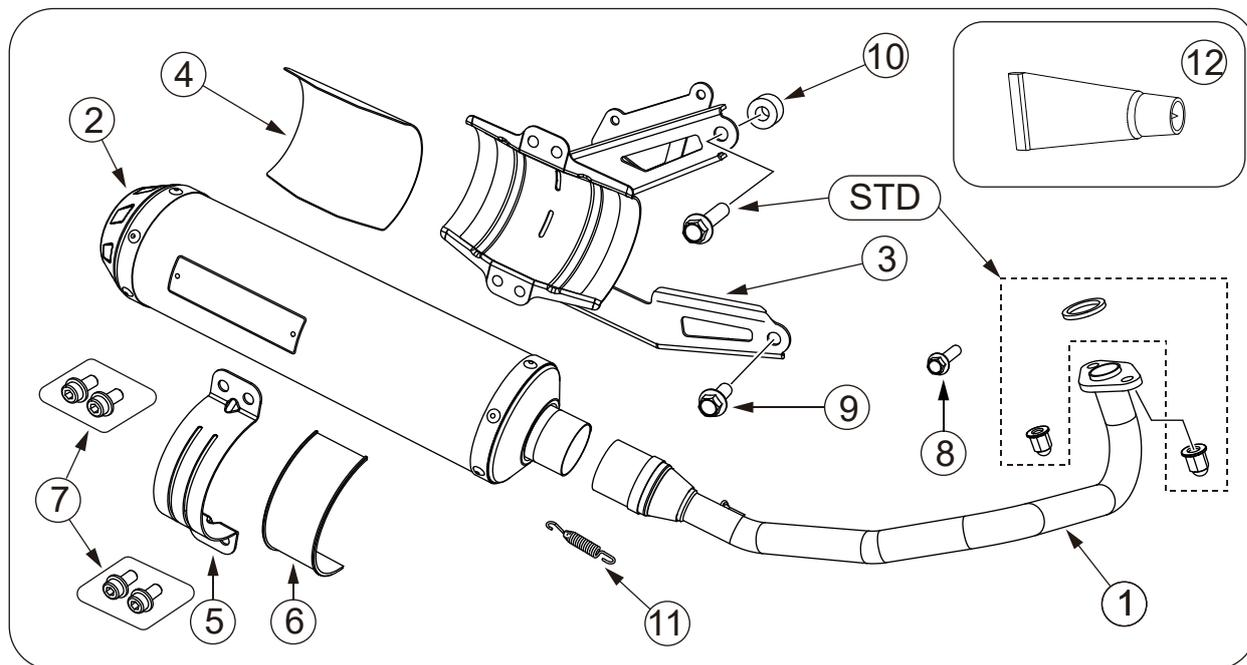
図中の **STD** は取り外した純正パーツを再使用します。
