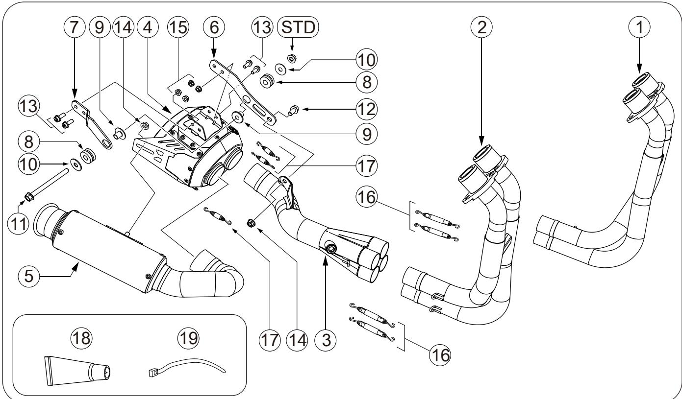
\*図中「STD」とは車両メーカーの純正部品の事です。製品取り付けに再使用します。
