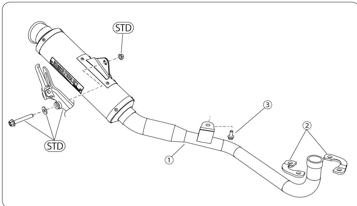
図中[STD]とはメーカー純正部品の事であり、取り付けに流用します。
