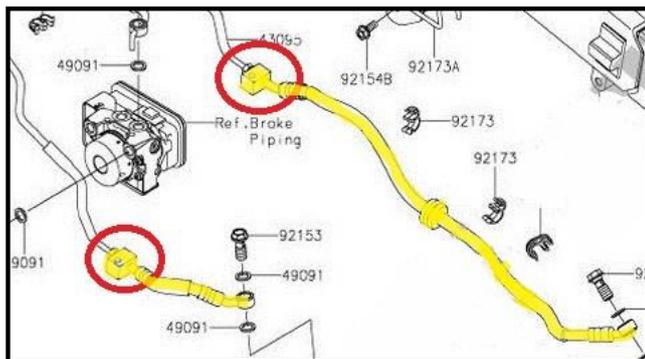
2: TYP710に008オリーブを挿入し純正配管と接続してください。
