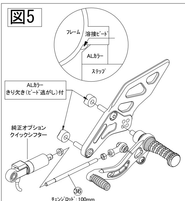
**△警告** タイロッドボルトとチェンジロッド、両側ピローボールとのねじ込み量をそれぞれ最低6mm（6回転）以上確保して下さい。6mm以下になるとネジ山を損傷し、チェンジロッドが外れる恐れがあり大変危険です
