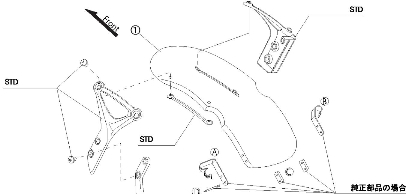
STD は取り外した純正パーツを再使用しますので、お手元に保管して頂くようお願いします。
